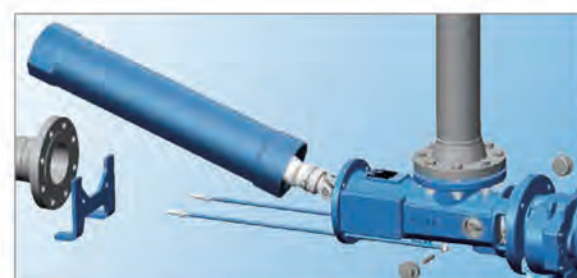
步骤3：把定转子、一端的十字万向节和联轴杆往前拉同时向上慢慢抬起，直到把整块从吸入室中取出来
