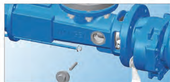
步骤2：拆掉吸入室上的检查螺栓，然后拆下十字万向节上的连接销
